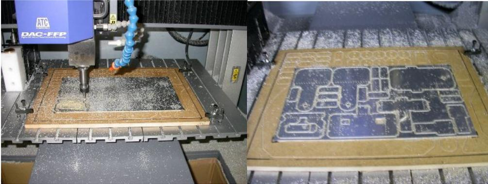
アルミ板の切削風景と、切削が終了した後のアルミ板
