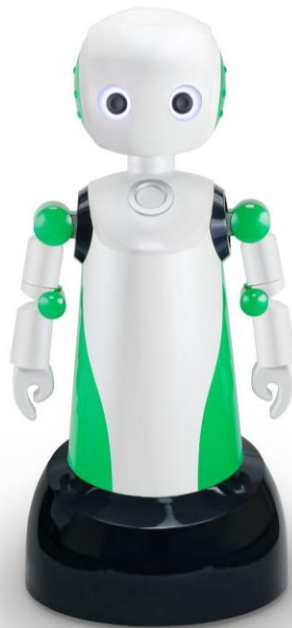
開発研究用ロボットプラットフォーム Robovie-R4
