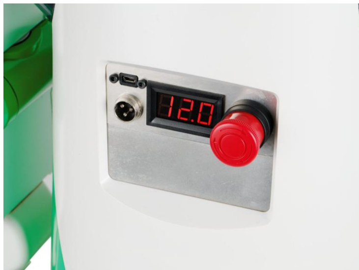
背面に電圧表示と非常停止スイッチを標準搭載
