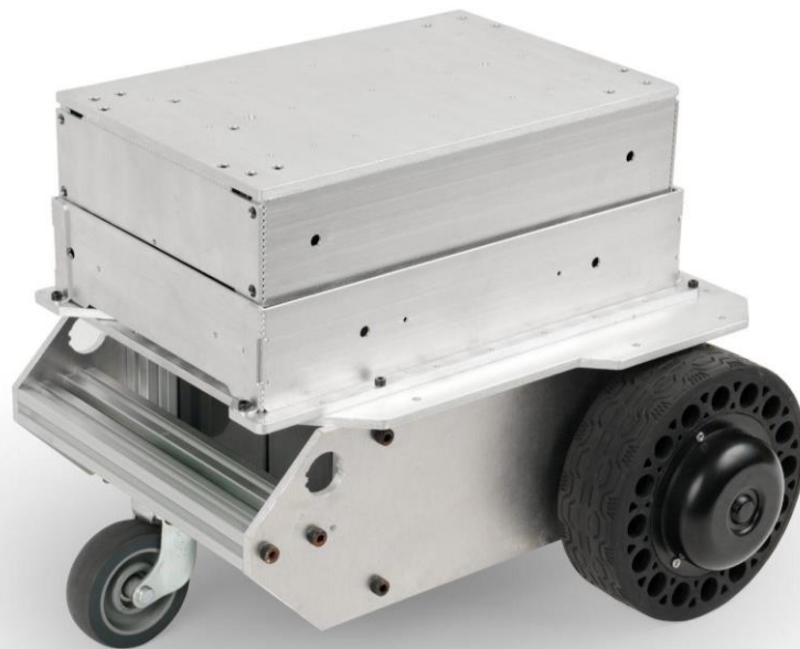
台車ロボット用 リフトオプション(メガローバーVer.3.0への搭載例)
