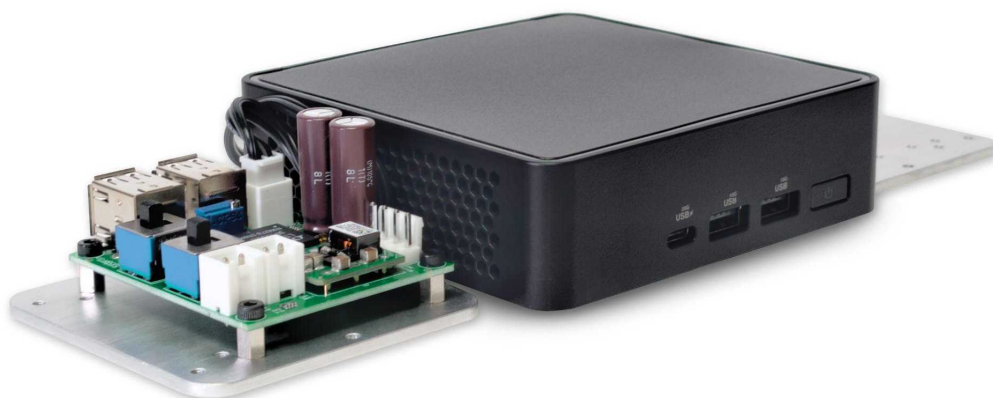
別売品 ROS PC(NUC14)オプション 参考画像 (拡張機器用電源基板 VS-WRC054を含む)
