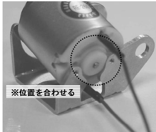
②出力シャフト側を矢印の方向に強く押しこみ、モーターを取り付けます。
