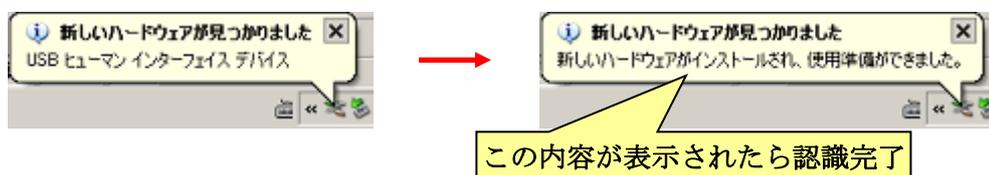
次に PC とロボットを接続したときには、フキダシを表示せずロボットを自動的に認識します。
