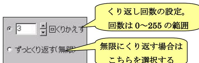
それでは早速くり返しを使ったプログラムを作成してみます。下図のプログラムを作成して実行してみましょう。プログラムを実行すると、ロボットが「1.5秒前進」→「0.5秒右旋回」という動作を3回くり返してプログラムを終了します。また、設定エリアでくり返し回数を変更すると、動作をくり返す回数が3回から変化します。
