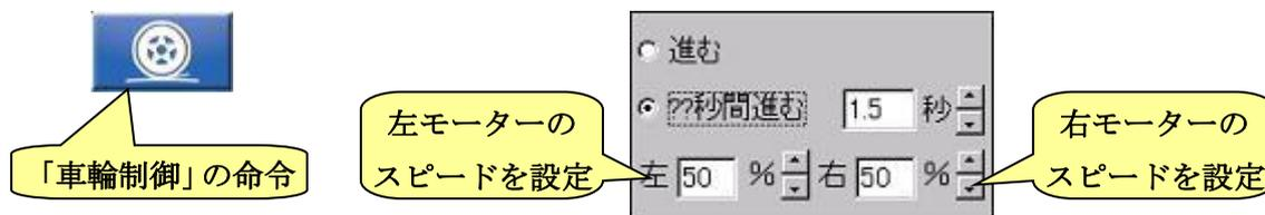
車輪制御の命令にも「??%」の設定がありますが、こちらは左右モーターの速度になります。数値は0~100の範囲で設定し、数値が大きいほどスピードが速くなります。左右のモーター速度の数値をそろえることで、任意の速さで前進させたり、任意の速度で「右前に進む」「左前に進む」のように柔軟な角度の旋回をさせたりすることができます。
