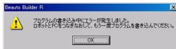
プログラムの書き込みに失敗する主な原因として、「書き込み中にロボットに触ったり動かしたりする」ことがあげられます。プログラムの書き込み中にロボットに触れると、通信が途中で途切れるなどして書き込みに失敗しやすくなります。書き込み中はロボットに触れず、書き込みが終わるまでなるべくそっと置いておいてください。
