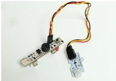
人感センサは何か動体を検知すると出力値が変化するセンサです。LED と組み合わせて使用することで、防犯ライトの仕組みを学ぶことができます。
