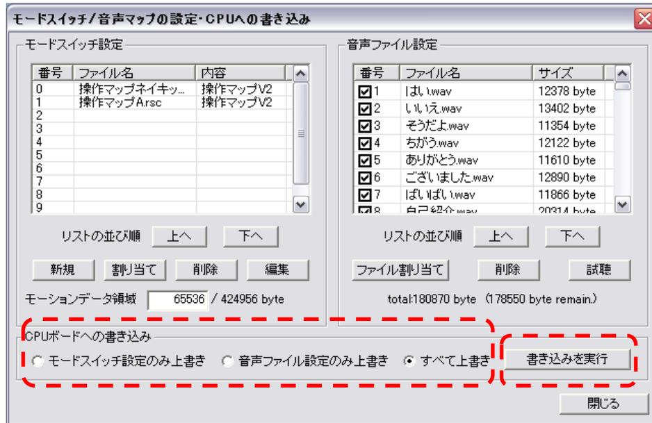
書き込みが完了したらサーボモータの位置補正は完了し、組立て作業もすべて完了です。
