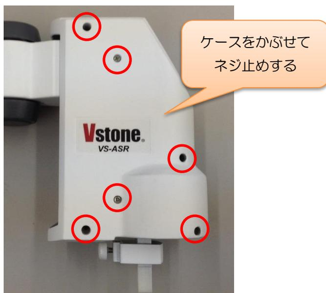
以上でペンタイプへの組み換えは完了です。ペンタイプは軸数が少ないため、SCARA Programmerで通信を行う際に、軸数を3軸に設定して行ってください。また、ペンの装着方法は、アカデミック スカラロボット取扱説明書をご参照ください。
