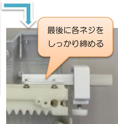
6. アーム上下軸のカバーをかぶせて、図中丸印内のネジを締めてください。
