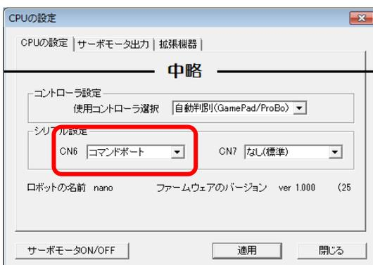
VS-BT001 を使用するためには、コマンドポート機能を有効にする必要があります。VS-RC003/HV でコマンドポートを有効にするには、RobovieMaker2 のプロジェクト設定>CPU の設定より、使用するコネクタのシリアル設定を「コマンドポート」としてください。
