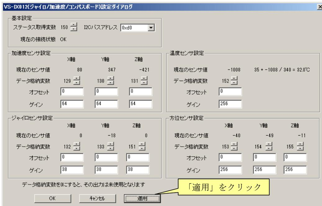
「現在の状態」が OK となり、現在のセンサ値が正しく表示されることを確認したら、必ず「モードスイッチ・音声の書き込み」を実施して設定を書き込んで下さい。
