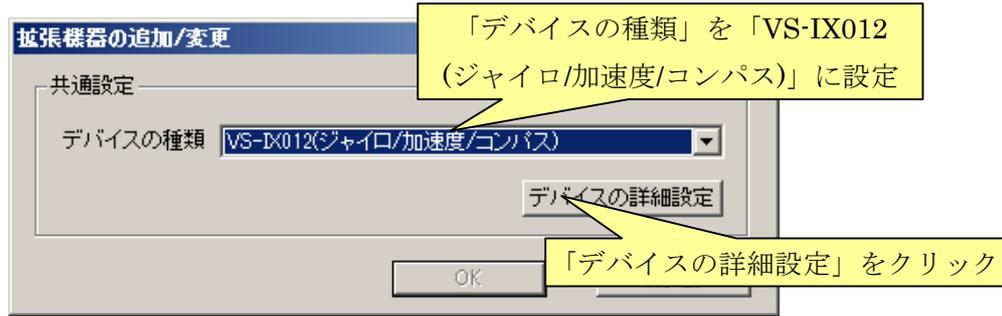
「VS-IX012(ジャイロ/加速度/コンパス)設定」ダイアログが開きます。「適用」をクリックしてください。確認画面で「OK」をクリックしてください。「現在のセンサ値」に現在の値が表示されるようになります。
